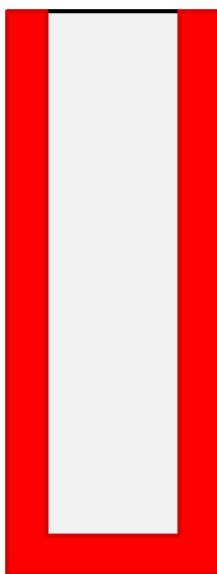
Figura 3.31: In rosso è evidenziata la zona erosa al termine della sperimentazione eseguita da Krampf sulla Trave B28.
