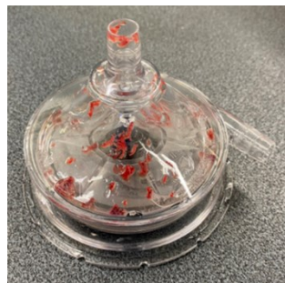
Figura 4.9 - Formazione di coaguli nella testa della pompa Medtronic®
