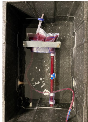
Figura 3.10 - Circuito bianco in funzione (A) con dettaglio all'interno del contenitore termico in polistirolo (B)
