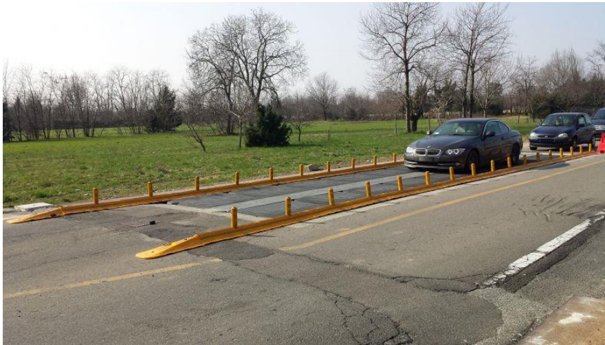
Figura 141 - Prototipo LYBRA dosso artificiale per immagazzinamento energia
