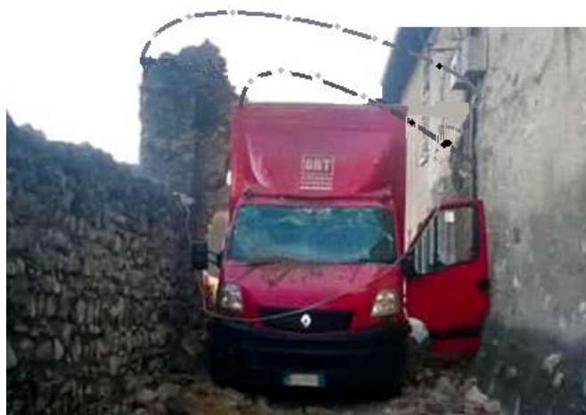
Figura 116- Veicolo troppo alto (foto di destra), abbattimento di un arco storico a Balbiana (BS) fonte: www.today.it
