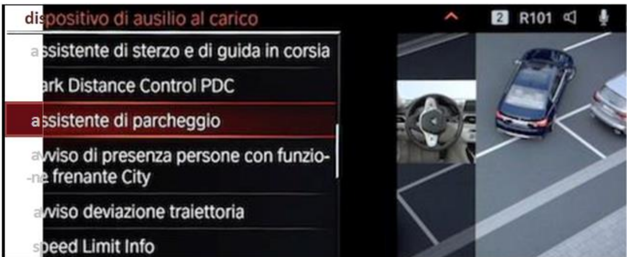
Figura 144 - Parking assistant plus di BMW, nella modalità a volo d'uccello fonte: MOTORCUBE
