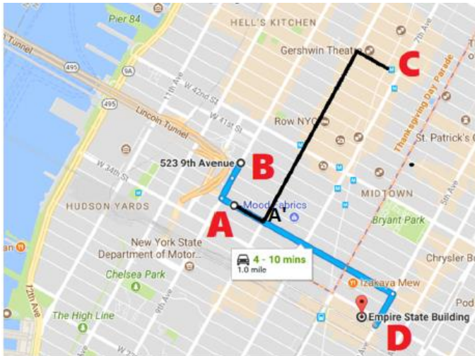
Figura 205 - L'attaccante fa credere al GPS che il veicolo è in B invece che in A, così invece di raggiungere D arriverà in C fonte: all you GPS are belong to us, Usenix
