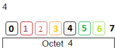
Figura 76 - Associazione delle informazioni ai vari bit del quarto ottetto fonte: ETSI TS 103 301 v 1.1.1
