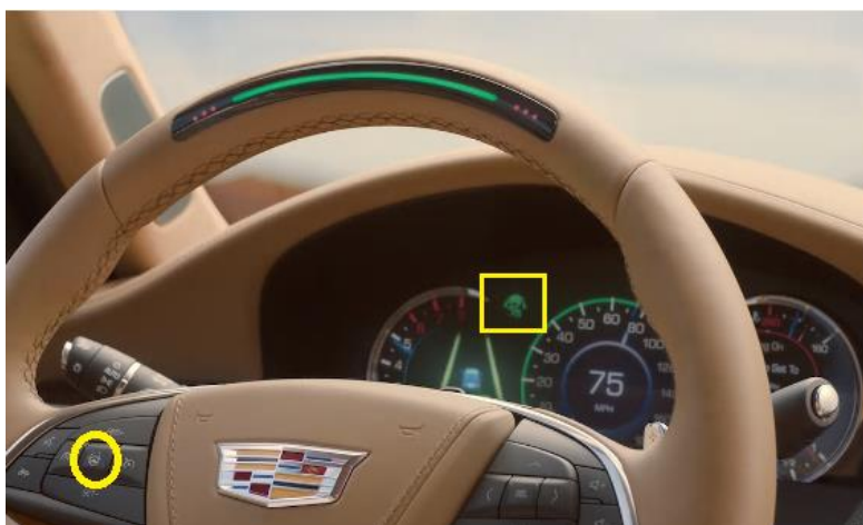
Figura 176 -Sul cruscotto di questa Cadillac si nota il simbolo che testimonia lo stato del Super Cruise, mentre sul volante è cerchiato il tasto per attivarlo-disattivarlo fonte: https://www.cadillac.com/ownership/vehicle-technology/super-cruise
