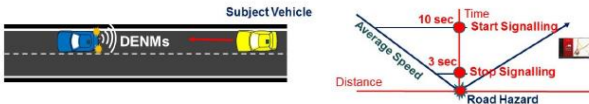
Figura 47 - veicolo a cui deve essere trasmesso il messaggio, di pericolo davanti. Diagramma di avvicinamento
