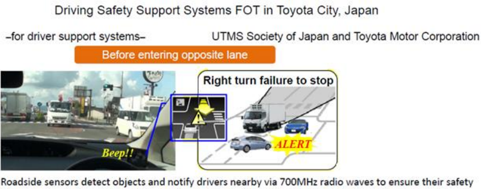
Figura 148 - Il radar di bordo evidenzia un pericolo nello svoltare a destra e avvisa il guidatore fonte: ITS radiocommunications standard and development in Japan
