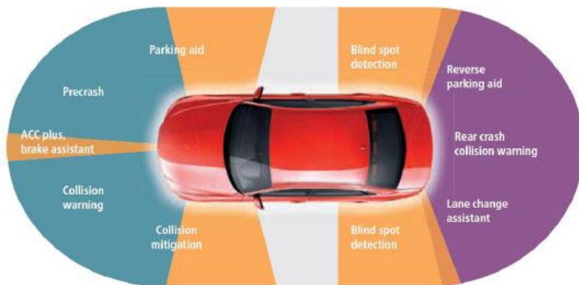
Figura 149 - Compiti del radar installato sul veicolo fonte: ITU-R, M. 2018
