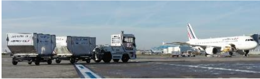
Figura 33 - autonom tract At135, in servizio dal Dicembre 2019 come trasporto pallet aeroportuali fonte: https://navya.tech
