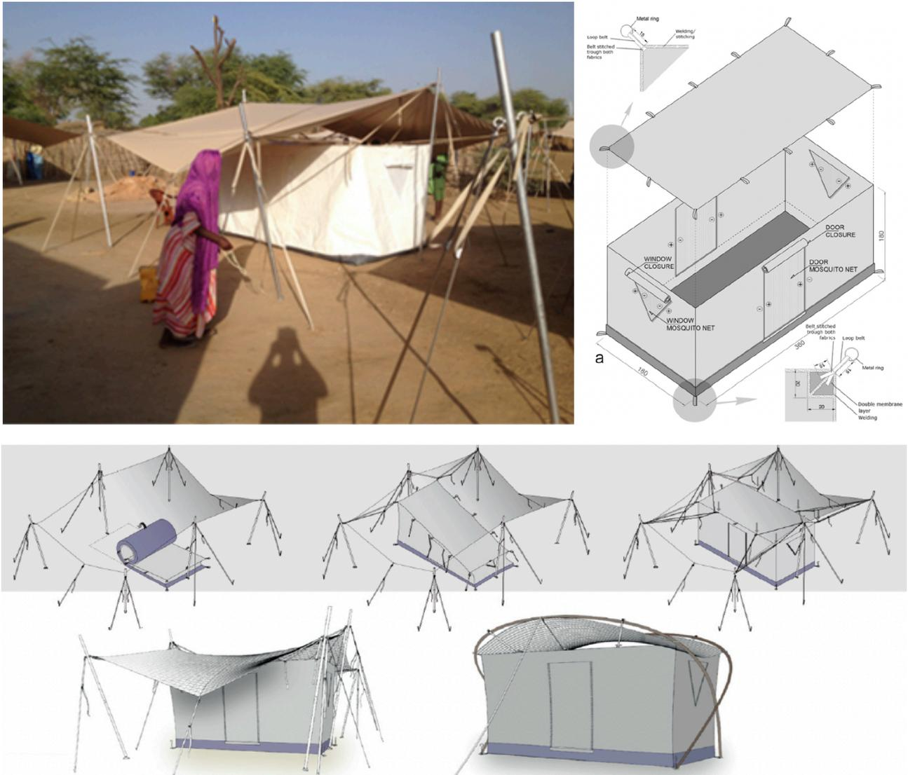
*Fig 2.5 Cocoon tent con schemi di montaggio*
