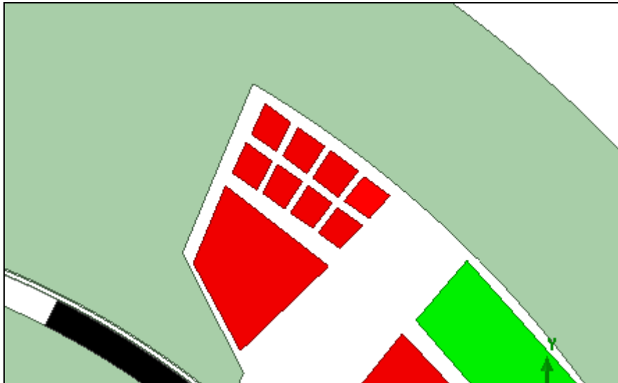
Figura 44: divisione in 8 parti di un lato attivo.
