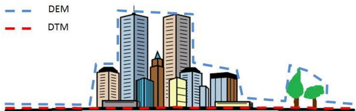
Figura 33 - Modelli di digitalizzazione del terreno DEM e DTM
