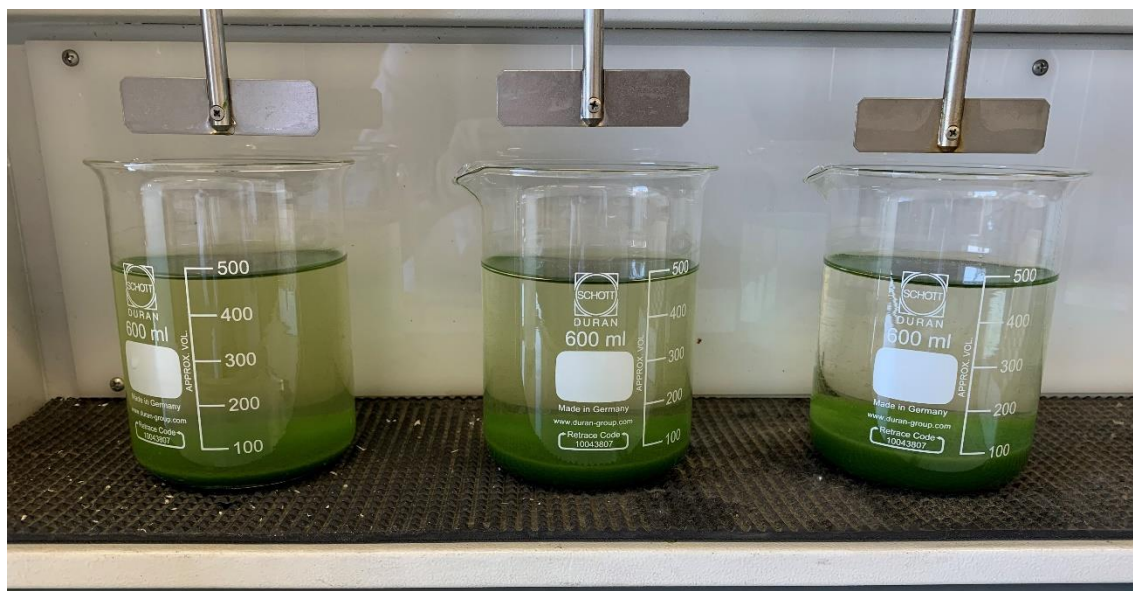
Figura 32: Risultati della prova condotta con solfato di alluminio su C6.
