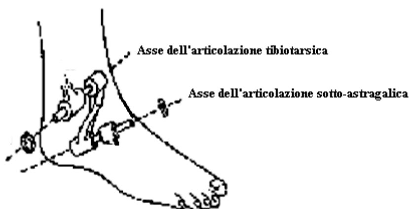
Figura 2.6 Primo modello meccanico del piede con asse di rotazione della tibiotarsica e asse di rotazione della sotto-astragalica.
