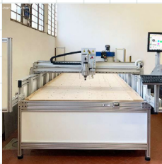
fig. 6 foratrice a ponte e individuazione della fase nello schema del processo produttivo
