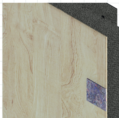
fig. 17 le pezze di feltro per il disaccoppiamento dal calcestruzzo
