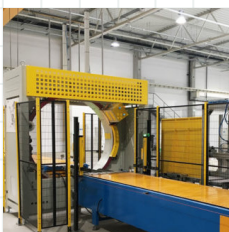
fig. 7 imballatrice e individuazione della fase nello schema del processo produttivo
