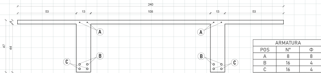
fig.36 sezione coppella K47 e relativa armatura a flessione
