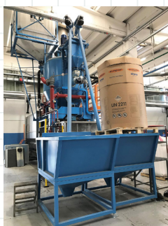
fig. 1. pre espansore e individuazione della fase nello schema del processo produttivo
