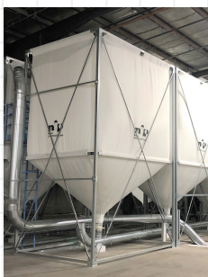
fig. 2 silos di espansione e individuazione della fase nello schema del processo produttivo
