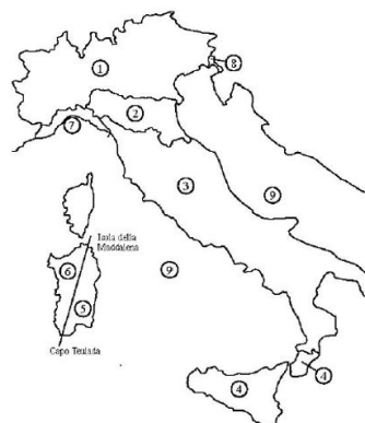
fig. 14 zone di carico della neve
