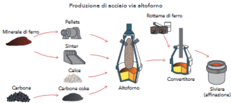
Figura 4.4 – Schema semplificato del processo BF-BOF. (Fonte [73]).
