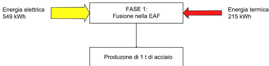
Figura 4.9 – Sankey diagram relativo al processo di produzione dell'acciaio nelle EAF. Elaborazione grafica basata su dati provenienti da RSE [10], per quanto riguarda gli assorbimenti di energia elettrica e termica della produzione di acciaio EAF.
