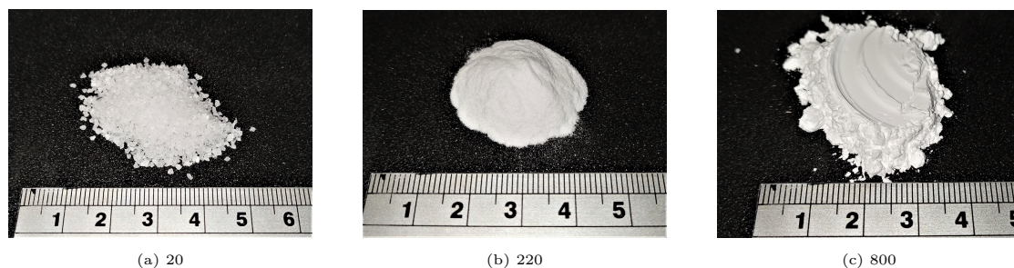
Figura 6.5: Le grane utilizzate nella sperimentazione, composte tutte di ossido di alluminio da frantumazione. Dimensioni decrescenti da sinistra.
