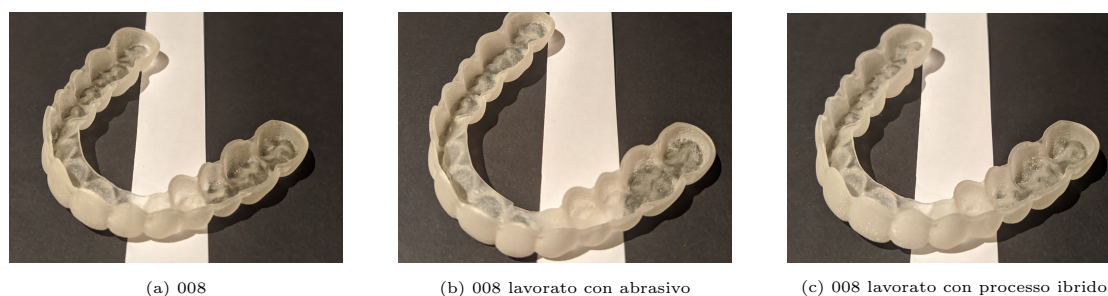
Figura 6.20: Provino 008 in MED625FLX base e rivestito in MED610, confronto tra il provino come stampato, lavorato con abrasivo e lavorato con abrasivo e solvente (da sinistra verso destra).
