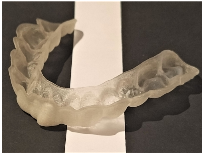
Figura 6.17: Provino 002 lavorato per 5 ore in IPA a 75 giri/min. Il provino mostra una lucentezza superficiale migliorata, sintomo della riduzione netta della rugosità micrometrica, nonostante la macro-rugosità sia ancora visibile. L'opacizzazione, infatti, permane nonostante il pezzo mostri maggiore brillantezza
