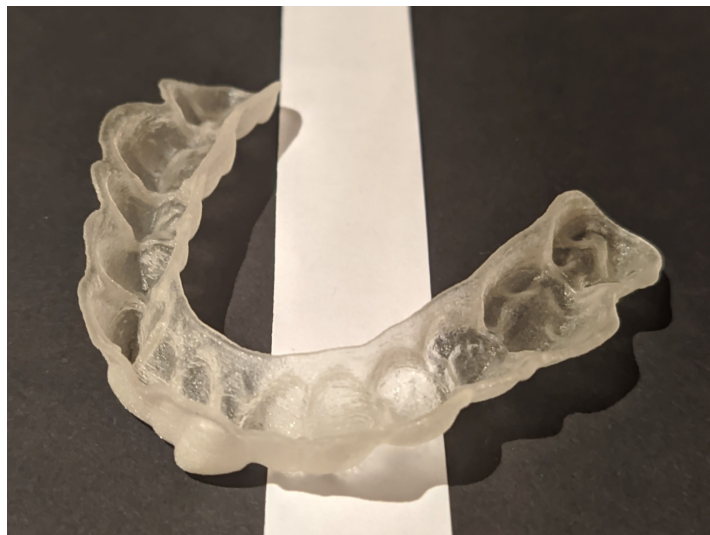
Figura 6.12: Provino 002, composto da sola MED610 con uno spessore di 0,5 mm, la colorazione risulta con un grado di ingiallimento minore rispetto ai provini con MED625FLX esterna.
