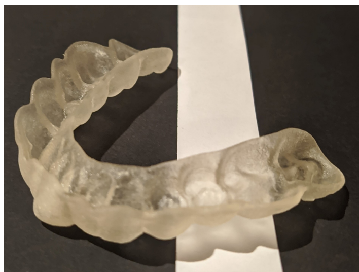
Figura 6.11: Provino 005, composto materiale base da MED610 con rivestimento in MED625FLX. Il provino mostra una leggera colorazione gialla.
