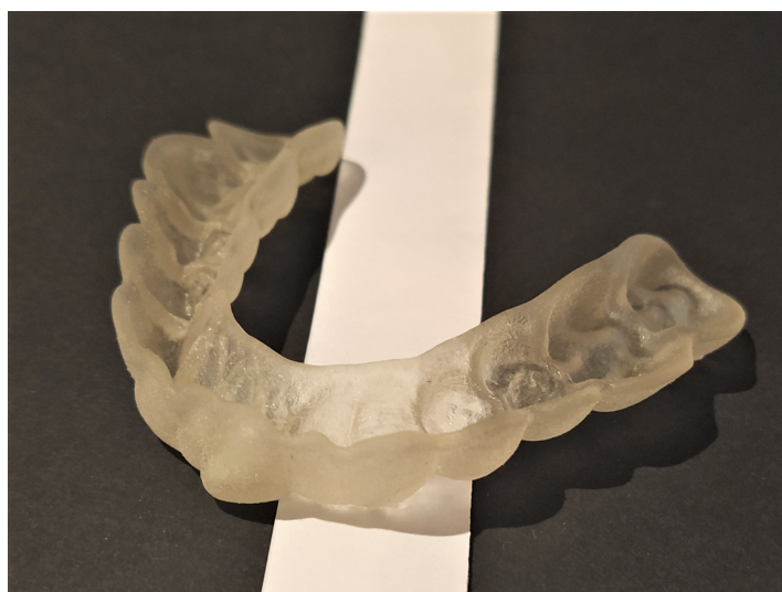
Figura 6.18: Provino 005 prodotto in MED610 materiale base con rivestimento in MED625FLX. Il provino mostra una superficie molto omogenea con parziale eliminazione dei difetti e dei segni di stampa.
