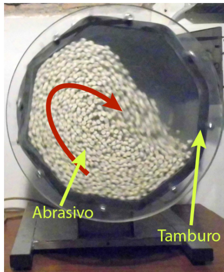
Figura 3.17: Esempio di processo di finitura a tamburo (Barrel Finishing), l'abrasivo ricircola all'interno della camera incidendo sul pezzo ed erodendo così la superficie. L'inclinazione del tamburo può generare tipologie diverse di flusso [2].
