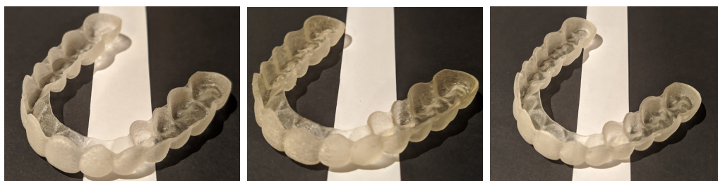
Figura 6.13: Confronto tra i diversi materiali di stampa sulla stessa dentatura. I codici dei provini da sinistra verso destra: 004, 007, e 008. Il provino 008, stampato con rivestimento in MED625FLX, mostra un grado maggiore di ingiallimento.
