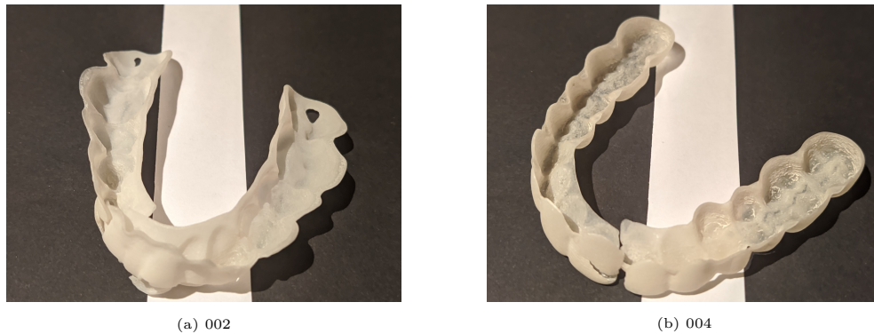
Figura 6.14: Allineatori in MED610 pura lavorati con il processo tramite abrasivo. La rottura di tali allineatori indica l'inadeguatezza di uno spessore così sottile per la produzione dei pezzi, oltre che un'estrema fragilità.
