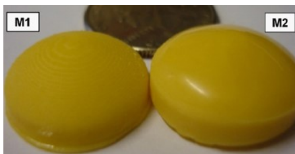
Figura 3.8: Risultati dell'utilizzo della resina residua per la formazione di menischi nei gradini dei layer [25]. Il campione M1 è stato stampato con la tecnica tradizionale e mostra evidenti segni di stampa costituiti dai gradini tra i layer, mentre il provino M2 è stato sottoposto a post-curing senza la rimozione della resina residua. Il risultato nel caso del provino M2 è di una superficie perfettamente liscia.
