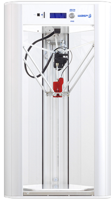
(a) Stampante ad assi paralleli. La serie Delta della Wasp posiziona l'ugello grazie a tre bracci snodati collegati a delle viti, questo permette un posizionamento accurato che consente anche un certo angolo di inclinazione ( https://www.3dwasp.shop/prodotto/stampante-3d-delta-delta-wasp-2040-pro/ ).
