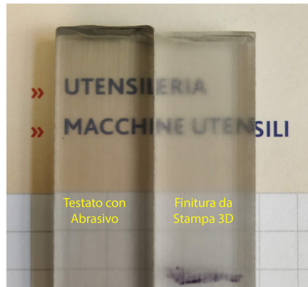
Figura 6.4: Risultati dei test preliminari effettuati su MED610 per osservare l'effetto dell'abrasivo e l'eventuale presenza di vuoti nel materiale. I test mostrano che il miglioramento tramite l'utilizzo di abrasivo è possibile, e inoltre che il MED610 risulta completamente riempito con assenza di vuoti nel materiale. Nella foto : a sinistra il pezzo in MED610 testato con abrasivo, a destra la parte con una finitura "as-printed".
