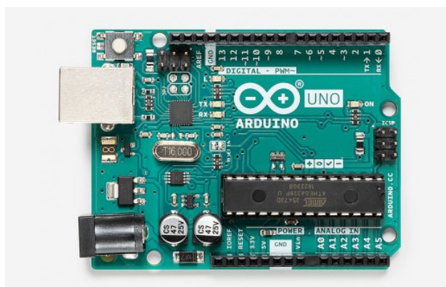
Figura 6.8: Scheda di controllo utilizzata per la produzione dell'apparato sperimentale di finitura a tamburo. Modello Arduino Uno REV3 ( https://store.arduino.cc/arduino-uno-rev3 ).
