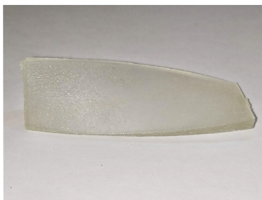
Figura 6.27: La rugosità nei provini che mostrano una superficie complessa e con curvatura nelle tre dimensioni possiedono una rugosità di stampa molto ridotta. I provini elicoidali sono stati stampati con l'asse dell'elica orizzontale, e mostrano una superficie che ruota dai 90^\circ a 0^\circ rispetto al piatto di stampa.
