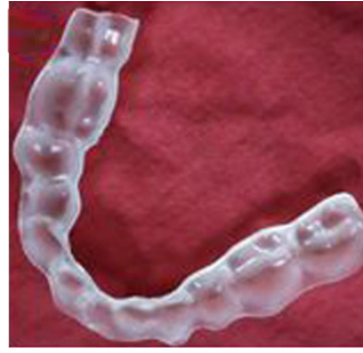
(b) Allineatore stampato in MED610 dopo il post-processing che prevede la rimozione tramite getto d'acqua del supporto (Fullcure 705).
