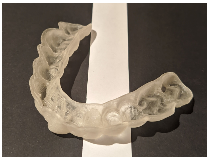
Figura 6.19: Provino 006 costituito da MED625FLX come materiale base e MED610 come rivestimento. I risultati sono simili a quelli conseguiti con il provino 002, per cui la lucentezza superficiale è incrementata, nonostante la struttura stratificata permanga.
