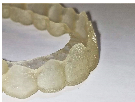
Figura 6.26: Dettaglio della superficie verticale al piatto di stampa del provino 008. La rugosità è evidente sulla porzione labiale dell'allineatore, verticale al piatto di stampa, mentre rimane poco accentuata nella porzione linguale che è invece leggermente inclinata.
