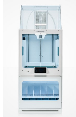
(b) Le stampanti più comuni prevedono tre assi normali tra loro, di cui generalmente due per lo spostamento dell'ugello e uno per il piatto, ma le configurazioni sono varie. In figura è rappresentata una stampante Ultimaker S5 Pro Bundle ( https://www.3ditalyshop.it/prodotto/stampanti-3d/ultimaker/ultimaker-s5-pro-bundle/ ).
