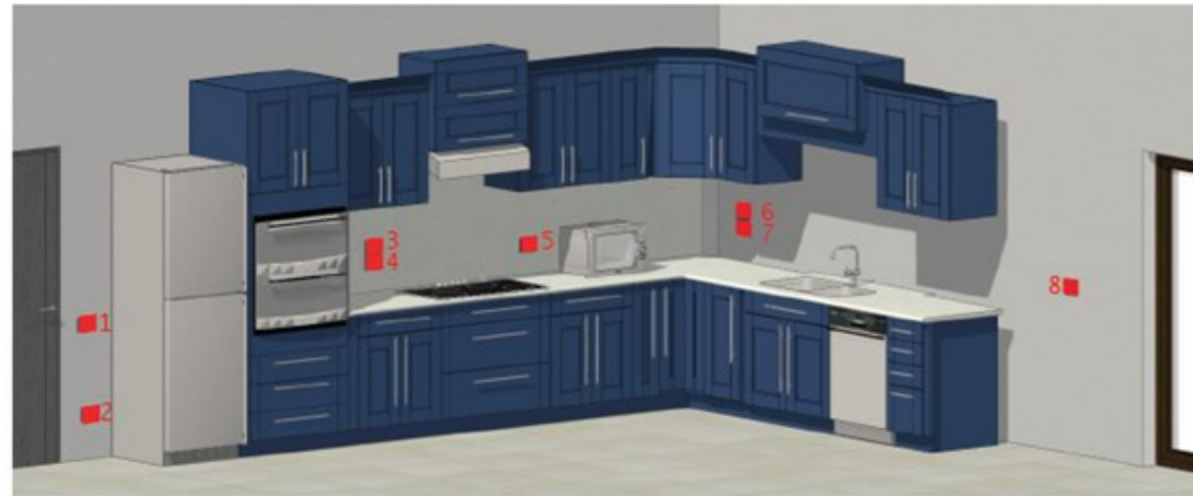
Fig. 8.7 Esempio di disposizione delle prese in cucina.
