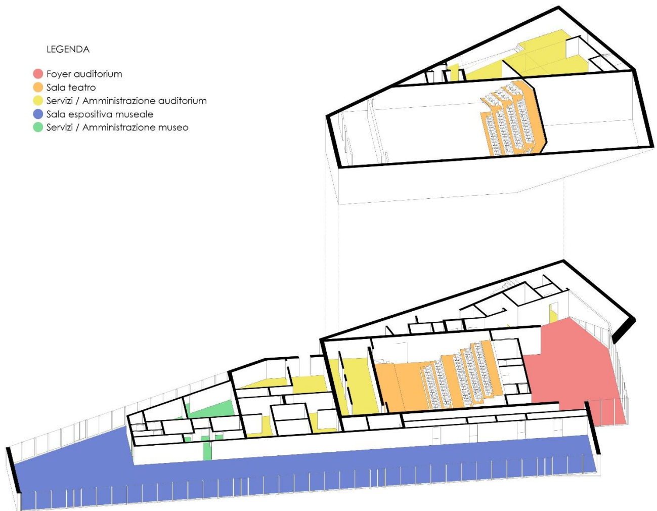
FIGURA 6.19 – Esploso: analisi delle funzioni
