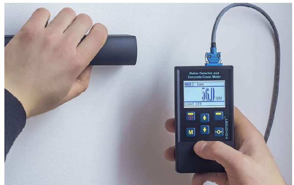
Fig. 11.4.1: Esecuzione di una prova pacometrica ( https://www.structuralsurveys.it/lavori/utilita-pacometro/ )
