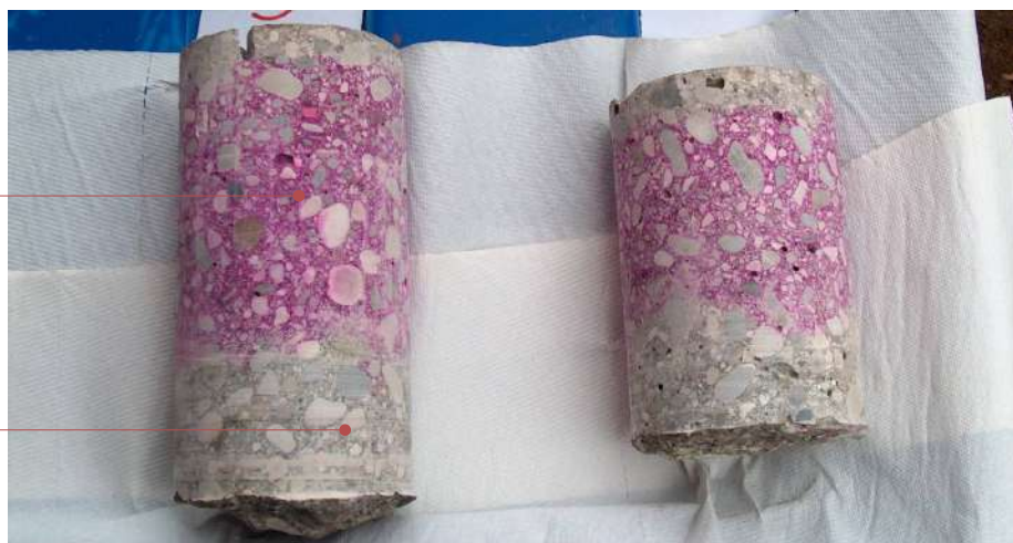
Fig. 11.4.2: Indagine carbonatazione su carote
