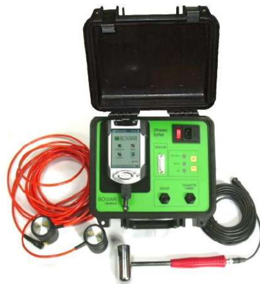
Fig. 11.4.4: Strumentazione per l'esecuzione di una prova sonica ( https://www.assorestaur.org/it/attivita/cuba-redi-ita/dai-qastories/da-qa-stories-cuba022017/prove-soniche.html )
