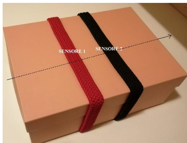
Figura 2.6: Esempio del posizionamento dei due sensori sull'oggetto rigido. Nell'immagine sono rappresentate le due cinture, l'oggetto rigido (una semplice scatola) e l'asse trasversale dell'oggetto rigido
