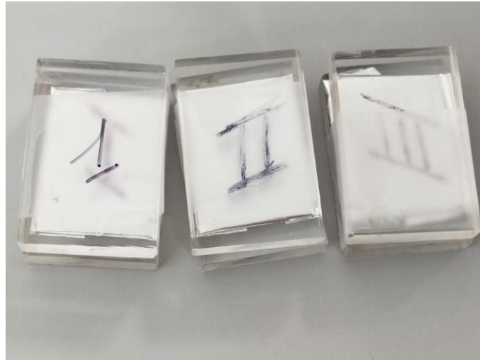
Figura 29: Configurazione dei pacchetti irradiati con sorgente gamma.
