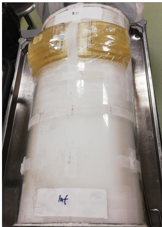
Figura 47: Fantoccio riempito di paraffina con mammelle in materiale tessuto-equivalente.
