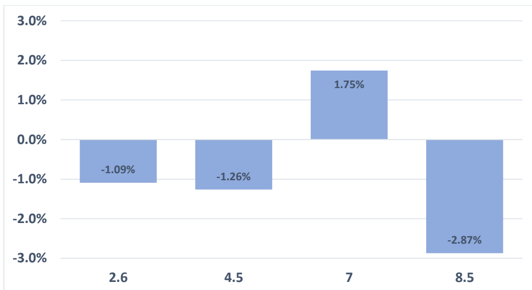
Figura 5.3: Variazione percentuale di portata alla sezione di chiusura a scala media annuale, di ogni scenario mediato tra tutti i modelli analizzati, nel decennio 2041-2050 rispetto al periodo di riferimento 2011-2020
