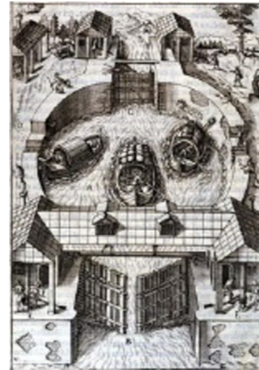
Image 5. Leonardo's Canal Lock. (Source: Zonca, Vittorio. Novo teatro di machine et edificii per varie et sicure operationi. Padova: Pietro Bertelli, 1607, p. 9.)
