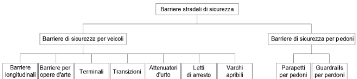
Figura 2 Tipologie barriere di sicurezza stradale
