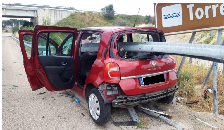
Figura 34 Conseguenze incidente contro terminale non adeguato
