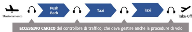
Figura 4.19: Odierno Schema di Funzionamento della Comunicazione Aeroportuale
