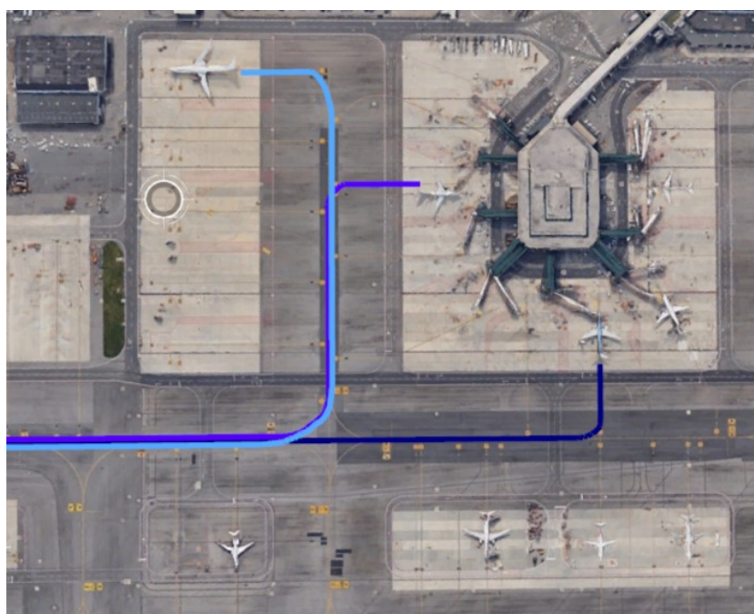
Figura 5.12: Programmazione itinerari con HMI. Gli itinerari sono in conflitto, dunque necessitano di un meccanismo di precedenza
