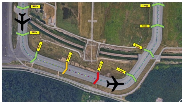
Figura 4.21: Configurazione del Sistema a Sezioni di Blocco
