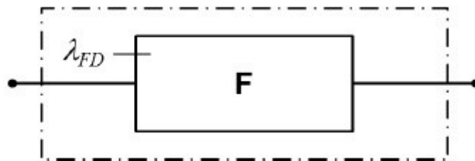
Figura 4.13: Sistema a canale singolo non testato (1001)
