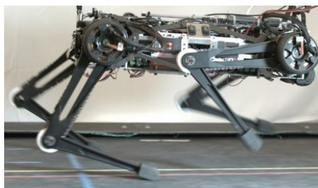
(b) Cheetah robot, Bledt, 2018, MIT [11]
