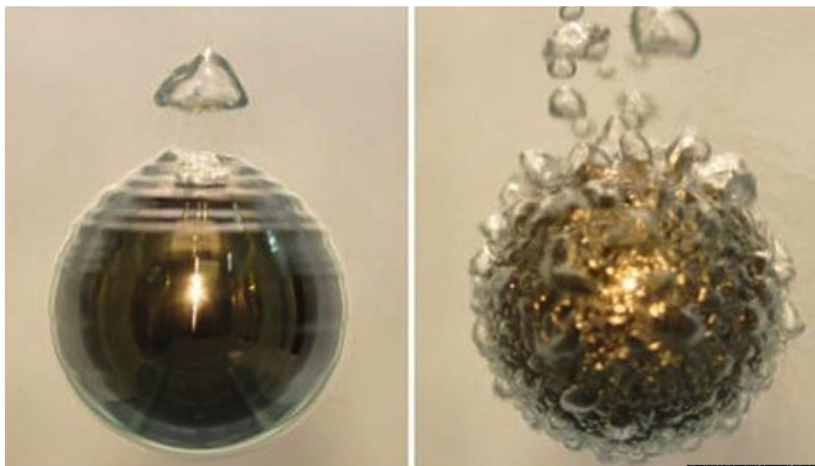
Figura 7: A sinistra: effetto del raggiungimento del flusso critico su di una sfera di metallo ad alta temperatura: DNB; a destra, il nucleate boiling, prima del raggiungimento del flusso critico (huffingtonpost.com)
