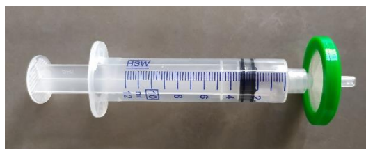
Figura 2.1.3 Complesso formato da siringa e filtro adoperati per filtrare la soluzione di eparina
