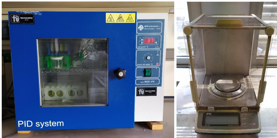
Figura 2.2.1 Stufa impiegata sia per scaldare la soluzione SWF a 37°C sia per riporre i campioni durante la prova di assorbimento (a sinistra); bilancia impiegata per eseguire le pesate a differenti time point per le prove di assorbimento e per le prove di ritenzione dei fluidi (a destra)
