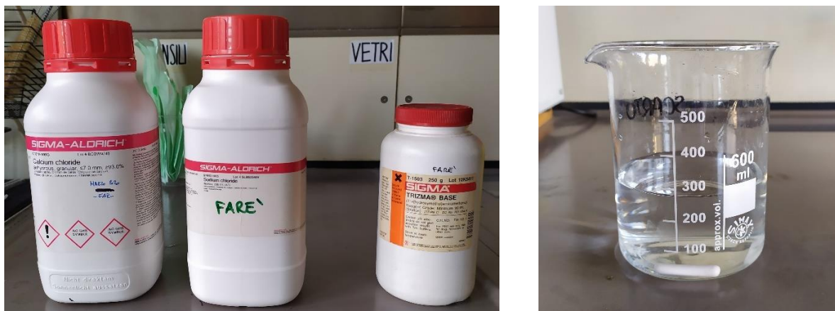
Figura 2.1.1 A sinistra sono riportati i tre reagenti principali per la realizzazione del Simulated Wound Fluid: cloruro di calcio, cloruro di sodio, TRIZMA. A destra è riportata la soluzione SWF finale realizzata a pH=7,5
