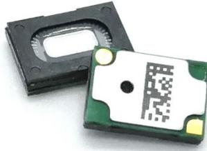
**Figura 3.7:** Dispositivo USound completo di piastra in alluminio e membrana polimerica. [13]
