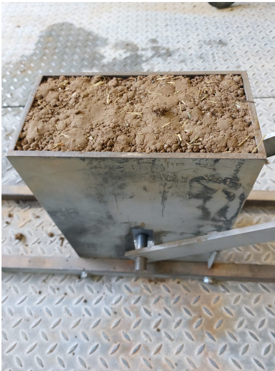
Fig. 9.19 - Step 3 : Filling of the Cinva Ram press mould
