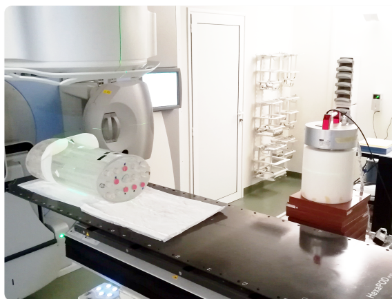
Figure 8. Fantoccio BOMAB con mammelle in silicone. A destra, il rivelatore LUPIN
