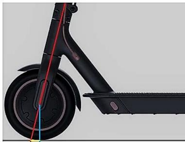
Figura 3 - Giallo: avancorsa; Rosso: asse sterzo; Blu: proiezione asse ruota
