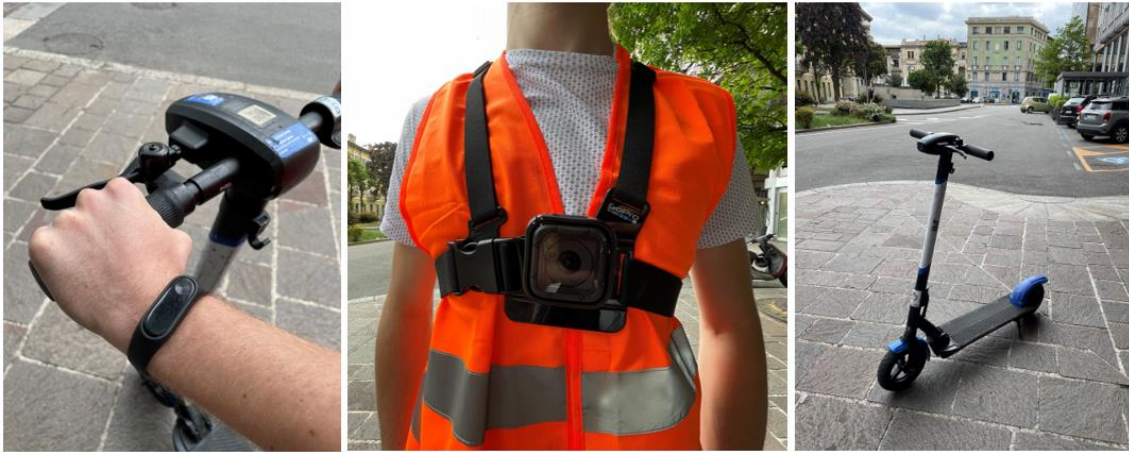
Figura 72 - Orologio Mi Band, Go Pro Hero Session 4 e monopattino BIT per le prove
