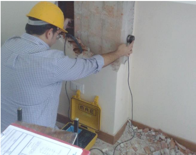
Figure 4.11 Ultrasonic test and its schematic replication. Sources: http://cmgtesting.it/prove-non-distruttive/pnd-calcestruzzo/ ; Presentation “Caratterizzazione delle strutture in calcestruzzo armato”, Prof. Lorenzo Cantini.
