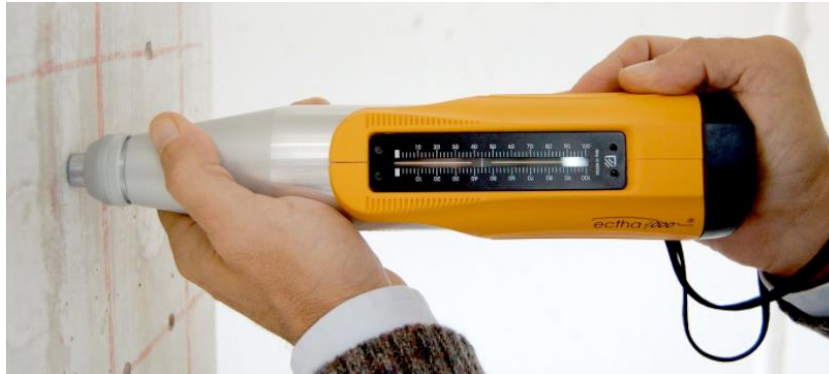
Figure 4.10 Sclerometric test. Source: https://www.volta.it/prodotti/misure/diagnosi-strutturale-per-edifici/sclerometri/sclerometro-calcestruzzo-meccanico/
