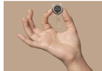
Il dispositivo N1 di Neuralink. I filamenti flessibili ("threads"), più sottili di un capello umano, contengono gli elettrodi per rilevare l'attività neuronale, puntando a una connessione ad alta larghezza di banda tra cervello e cloud.
