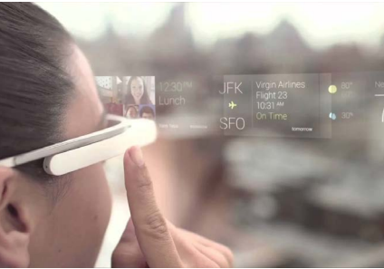
L'interfaccia di Google Glass (2013). Un esempio di Heads-Up Display (HUD): l'informazione fluttua in un piano fisso rispetto all'occhio, creando distrazione e fallendo nell'integrazione contestuale con l'ambiente fisico.
