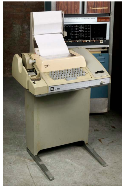
Un terminale Teletype (TTY). Con il Time-Sharing nasce l’interazione in tempo reale, ma il dialogo uomo-macchina avviene ancora tramite output cartaceo impresso meccanicamente.
