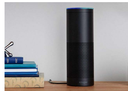
Amazon Echo (1a generazione, 2014). Un esempio radicale di design “Zero-UI”: la rimozione totale dello schermo costringe l’interazione a basarsi esclusivamente sulla voce, eliminando l’affordance visiva ma permettendo un uso ambientale.
