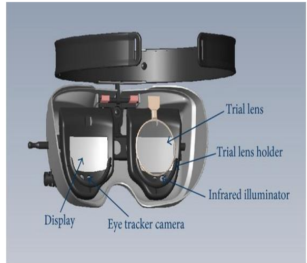
Fig. 3.1.2 VR glasses con due display
