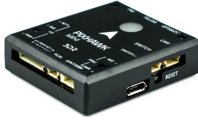
Figure A.3: Pixhawk Mini FCU from [289].
