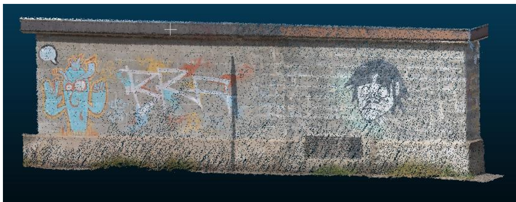
Figura 5.4: In alto, nuvola di punti da LiDAR con colorazione di GOpot; in basso, nuvola di punti da LiDAR con colorazione di Metashape
