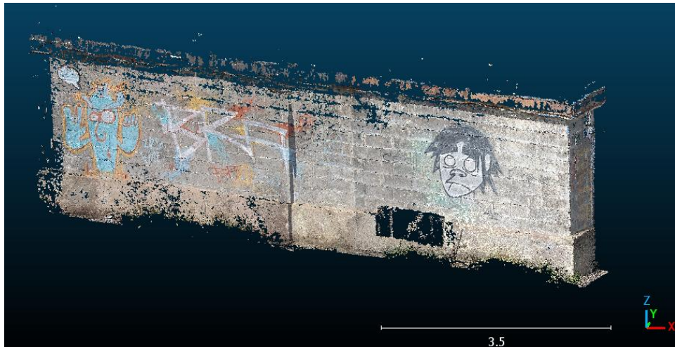
Figura 5.2: Nuvola di punti fotogrammetrica densa del murales
