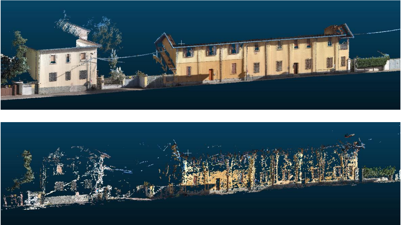
Figura 7.2: Porzione di nuvola di punti degli edifici del lato sinistro della strada derivanti da LiDAR colorata con Metashape (sopra) e da fotogrammetria (sotto)
