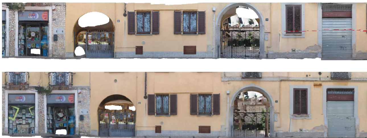
Figura 6.8: Dettaglio delle ortofoto LiDAR relative a una porzione di facciata degli edifici della piazza; sopra, derivante dalla prima acquisizione; sotto, derivante dal secondo rilievo
