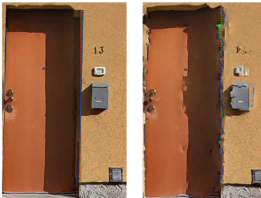
Figura 7.6: A sinistra, distanze dalla linea di riferimento della porta per l'ortofoto dalla nuvola di punti LiDAR; a destra, la stessa dalla nuvola di punti fotogrammetrica
