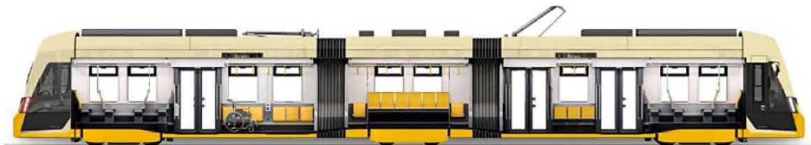
Fig. 4.8 Layout tram bidirezionale (fonte: stadlerrail.com)
