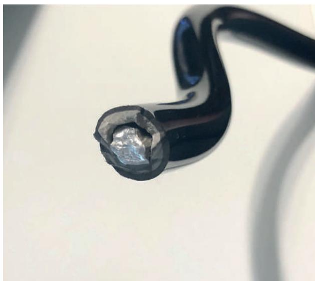
Il corpo tubolare di questi sostegni è composto da un tondino in alluminio, facilmente malleabile, rivestito da un doppio strato di gomma. Lo strato più interno più spesso ingloba il tondino metallico svolgendo il compito di protezione ed irrobustimento strutturale. Quello più esterno, oltre a fornire un'ulteriore protezione all'intero tubolare, svolge una funzione estetica.
