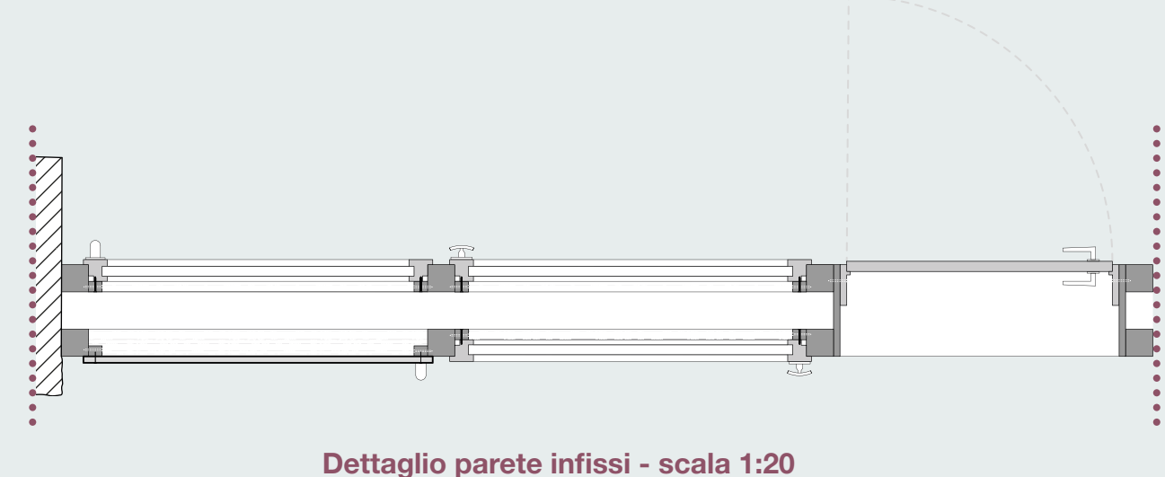
Dettaglio parete infissi - scala 1:20
