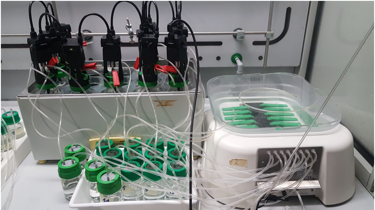
Figura 3.5 – Prova di misura del BMP in funzione con strumentazione AMPTS
