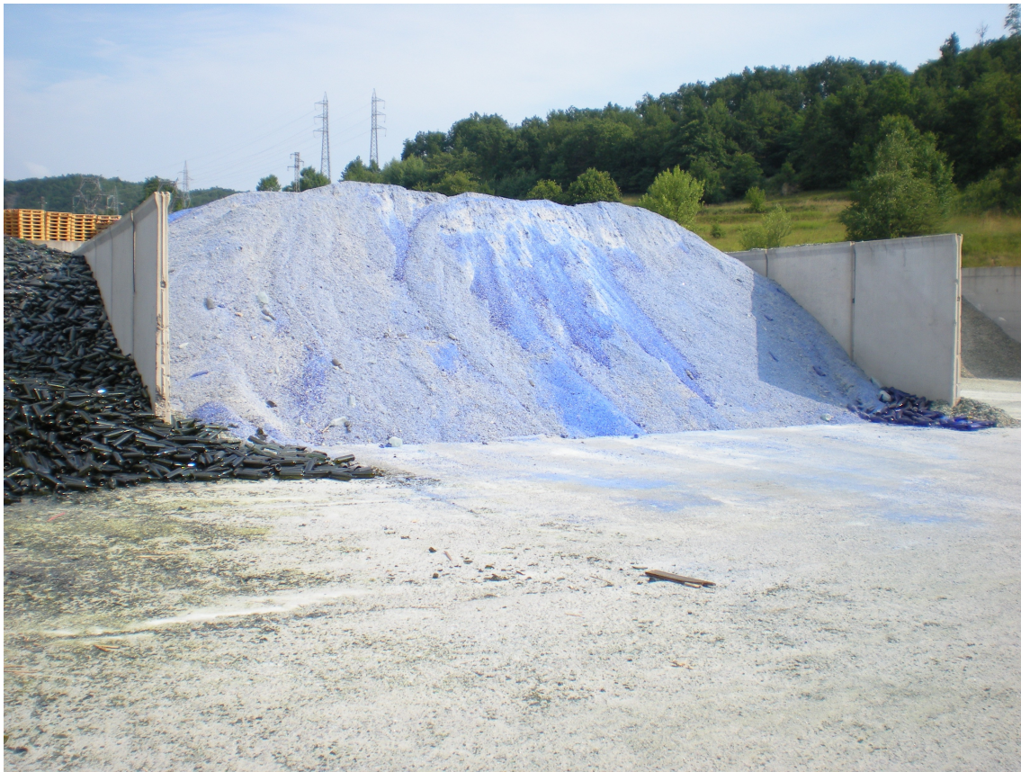
Fig 6.3: Rottame di vetro pronto ad essere riutilizzato
