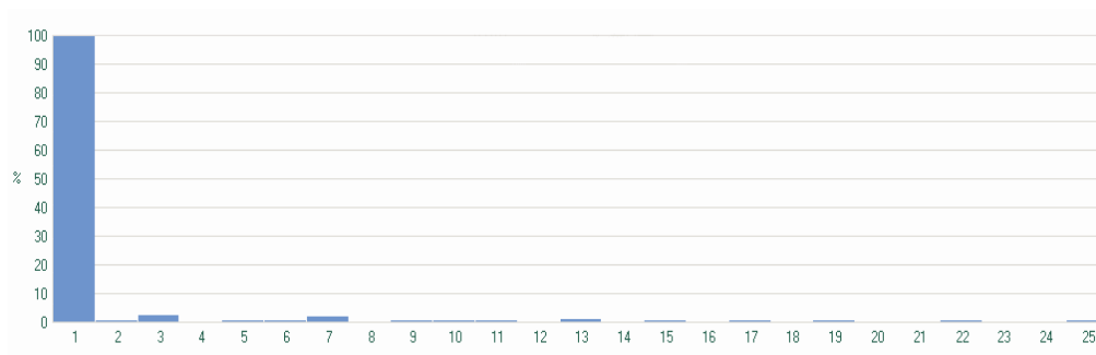
Fig.3.7 Corrente assorbita dalla linea con inverter rigenerativo (forma d'onda e spettro delle armoniche)
