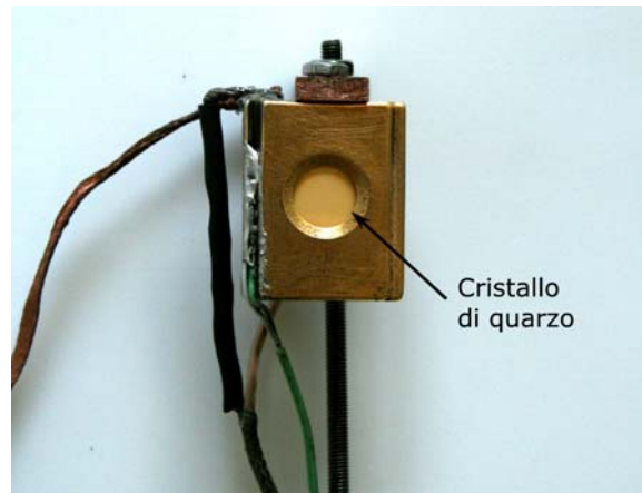
Figura 2.7 – Una QCM del tipo utilizzato nelle nostre misure
