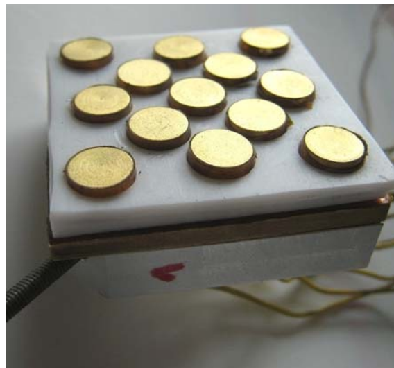
Figura 3.10 – Montaggio con piastrina più teflon
