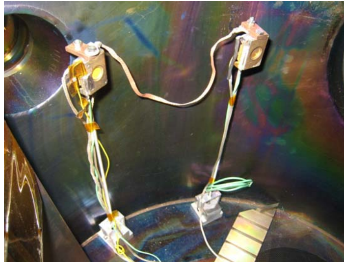
Figura 3.12 – Montaggio delle QCMs (test)
