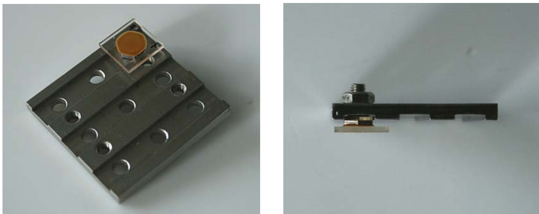
Figura 3.2 – Montaggio dei campioni
