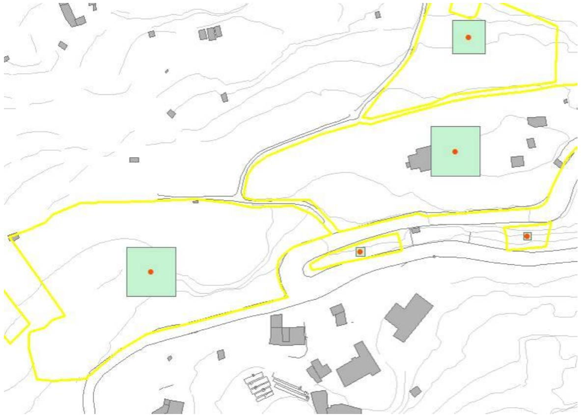
Carta 8 – Costruzione dei volumi generabili: I cassoni rappresentativi degli ipotetici edifici realizzabili sono parallelepipedi a base quadrata. Convertito lo shape file poligonale delle istanze (giallo) in puntuale (arancione), si è provveduto a generare i quadrati (in azzurro) centrati nel baricentro dell'istanza e aventi come lato la misura ottenuta dalla radice quadrata del rapporto volume massimo / altezza massima = superficie massima dell'edificio realizzabile.
