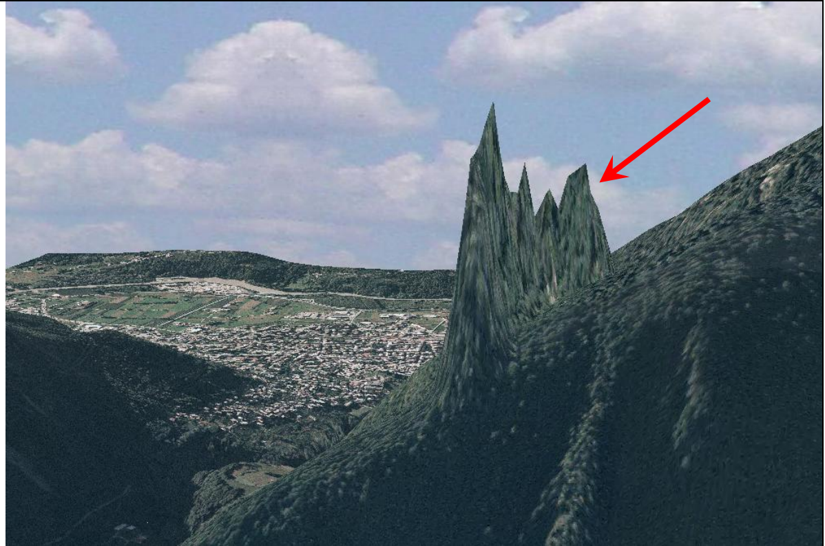
Carta 13 - Modello digitale del terreno creato con curve di livello aventi valori di elevation errati
