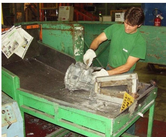
Fig. 9.3 Presbavatura di una scatola cambio
