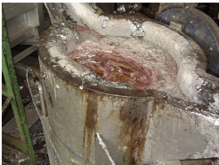
Fig. 1.10 Trattamento di degasaggio in siviera con setto poroso
