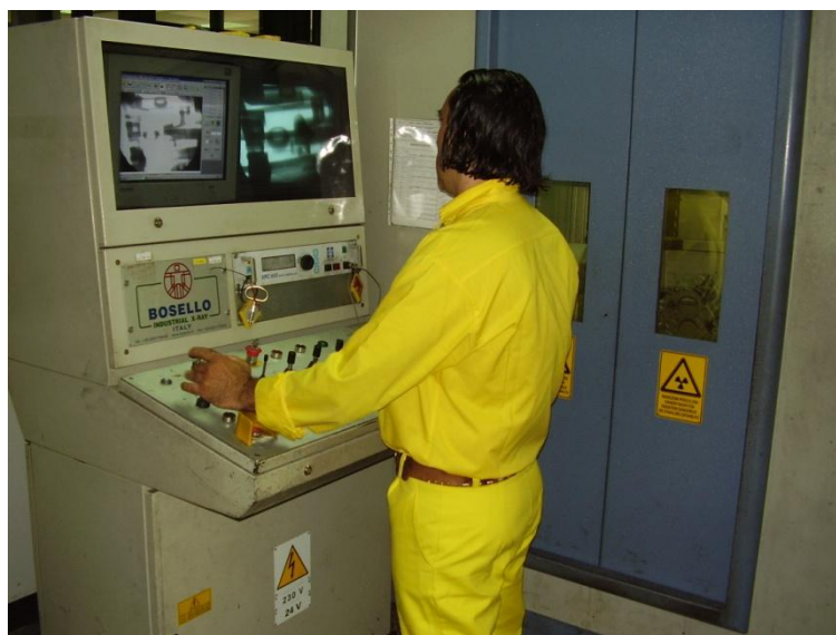
Fig. 3.1 Esecuzione del controllo radiografico
