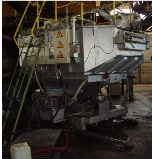
Fig. 1.24 Forno dosatore tipo Striko-Westofen
