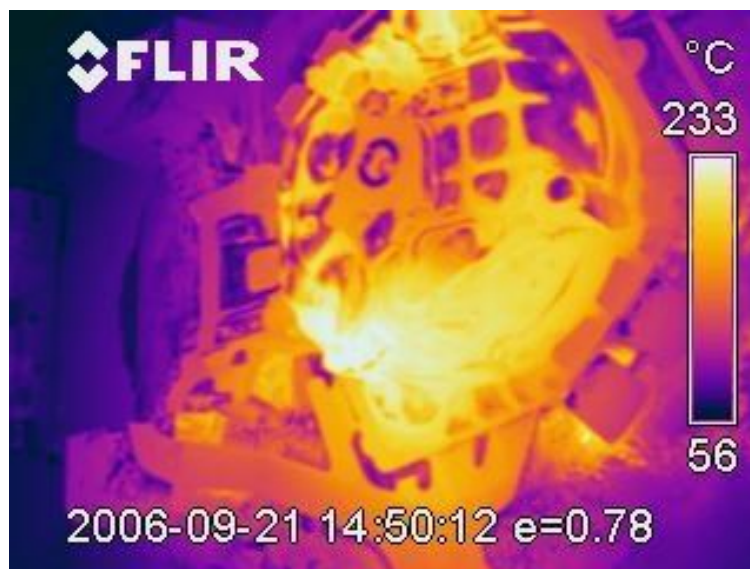
Fig. 8.19 Parte fissa prima della lubrificazione (230°C circa nel punto più caldo)
