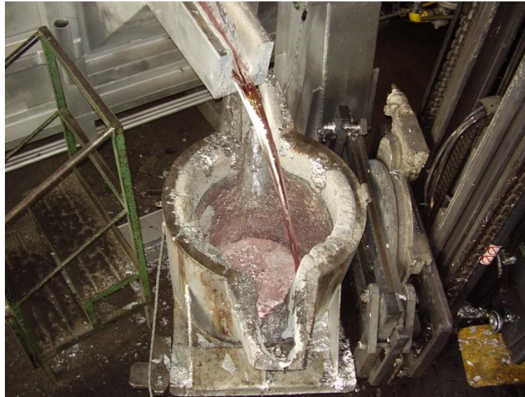
Fig. 1.26 Spillaggio con siviera carrellabile
