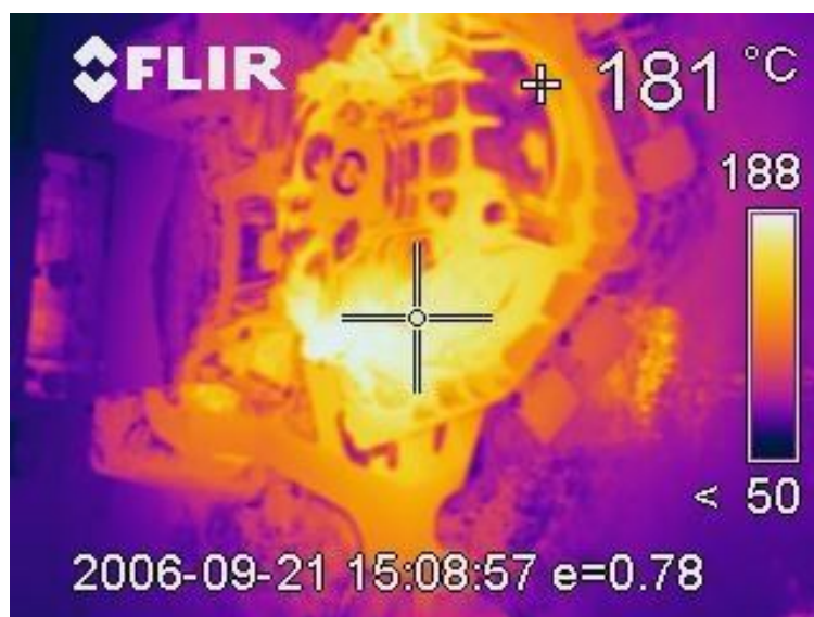
Fig. 8.20 Parte fissa dopo la lubrificazione (180°C circa nel punto più caldo)
