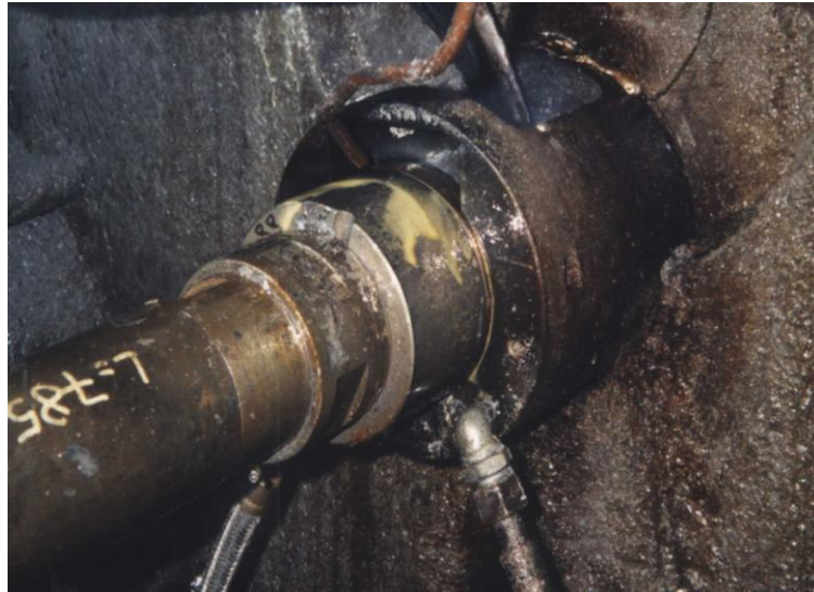
Fig. 6.24 Pistone in acciaio con fasce in Cu
