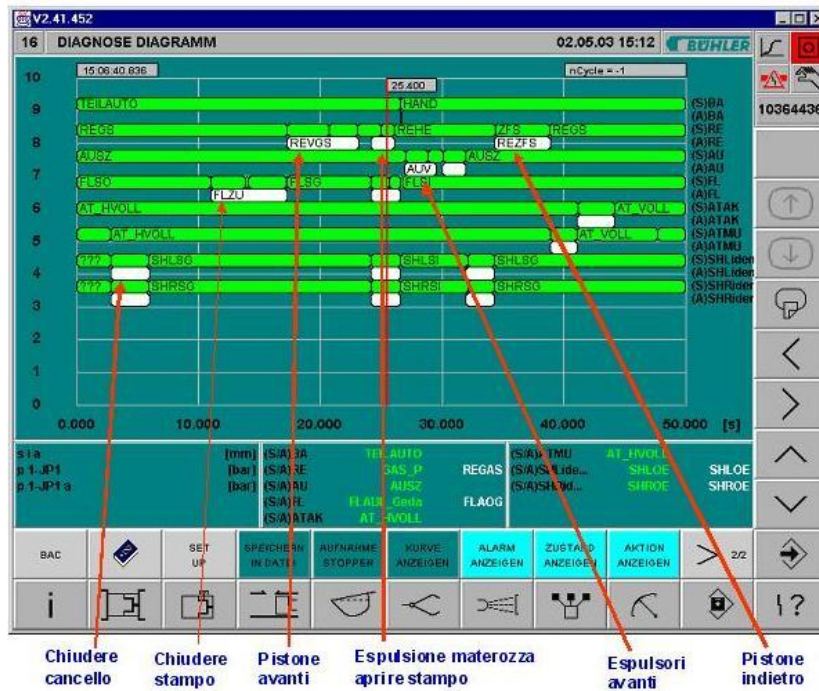
Fig. 4.8 Immagine dal pannello di controllo: analisi tempo ciclo
