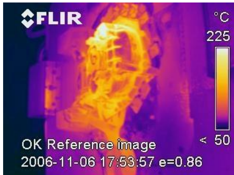
Fig. 8.18 Piano fisso prima della lubrificazione
