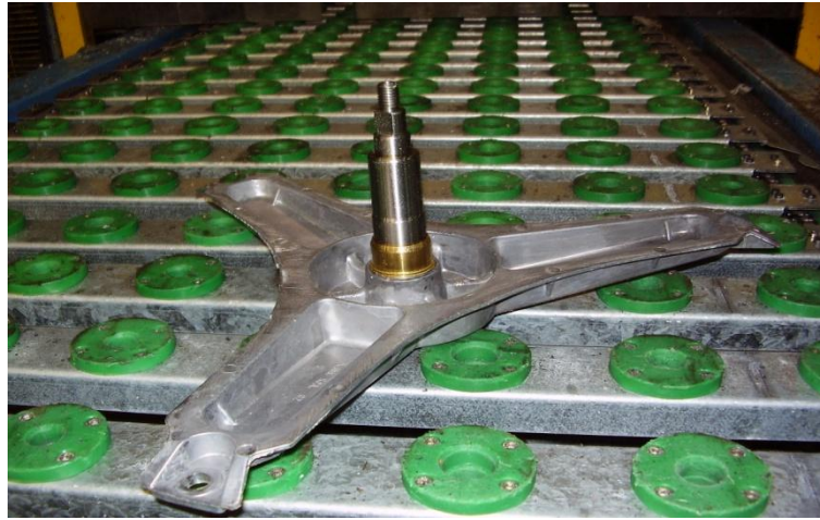
Fig. 2.12 Getto con inserto di acciaio
