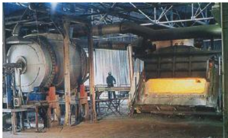
Fig. 1.17 Forno rotativo collegato al forno fusorio
