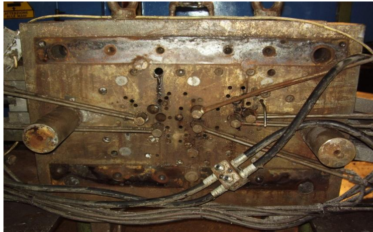
Fig. 2.11 Vista posteriore dello stampo e dei circuiti di raffreddamento
