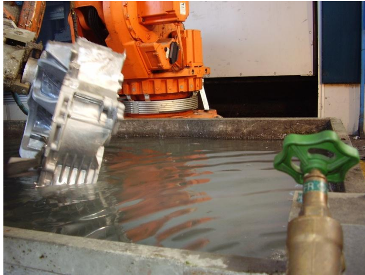
Fig. 2.9 Immersione di un getto nella vasca di raffreddamento
