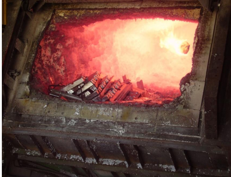
Fig. 1.18 Carica dei lingotti in forno a suola secca
