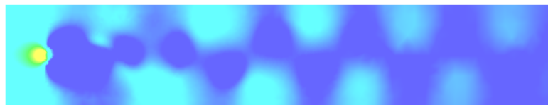
Figura 4.6: Campo di pressione a t = 7s . La scala dei valori va dal minimo di -5.76 \cdot 10^{-5} associato al colore blu, passando per un valore di 1.1635 associato al colore verde, arrivando al massimo di 2.327 associato al colore rosso.
