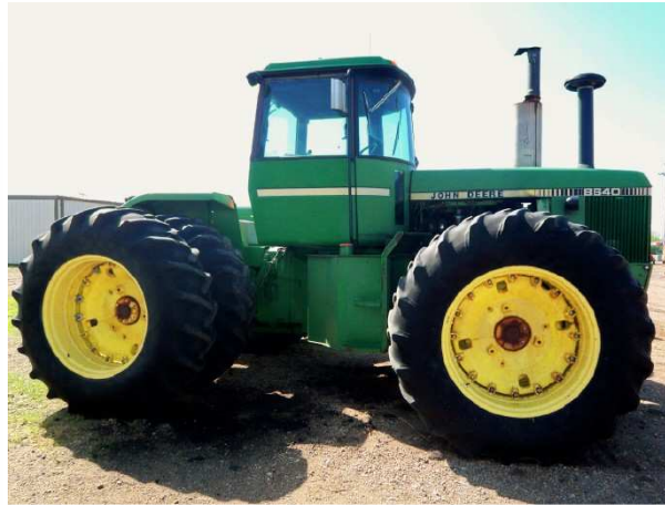
Figura 1.15- Sterzata con trattore articolata e trattore snodato John Deere 8640.
