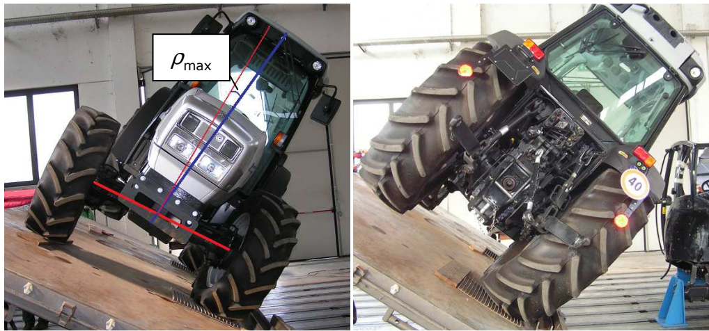
Figura 3.25- Trattore dopo il primo distacco della ruota posteriore a sinistra (sinistra) ed il secondo distacco della ruota anteriore a sinistra (destra).
