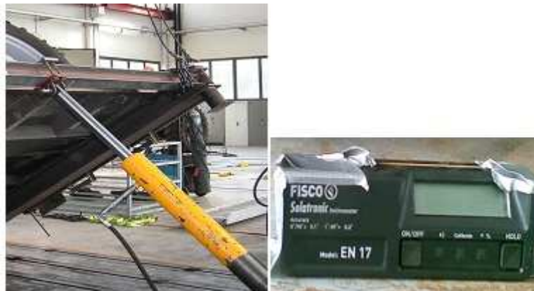
Figura 3.24- Attuatore idraulico collegato alla piattaforma (sinistra) e inclinometro (destra).
