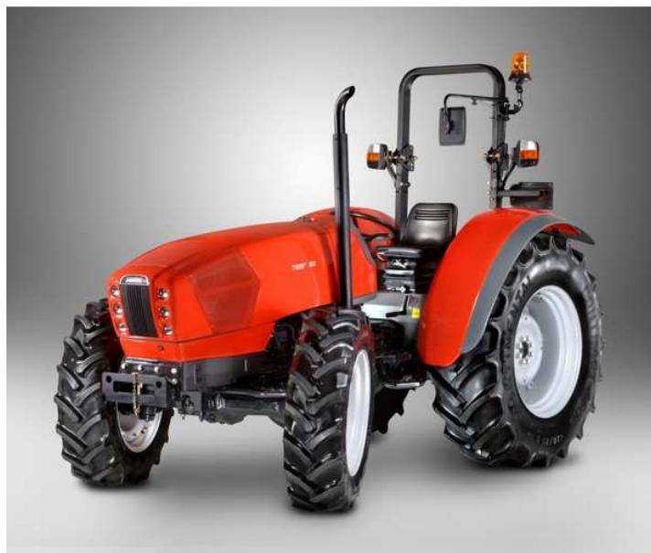
Figura 1.3- Esempio di trattore con sala anteriore basculante, Same.
