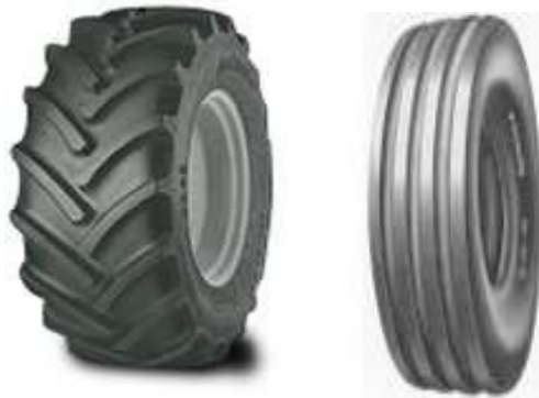
Figura 1.13- Pneumatici anteriori quattro ruote motrici (sinistra) e due ruote motrici (destra).
