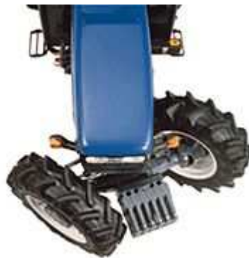
Figura 1.14- Supersteer di New Holland, con assale sterzante.
