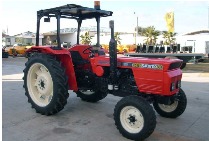
Figura 1.2- Trattore a trazione posteriore, Same.
