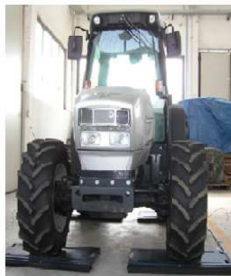
Figura A.0.1- Trattore in fase di pesatura.
