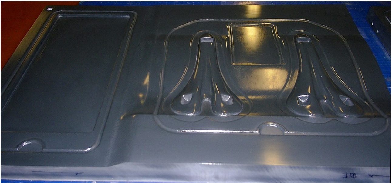
Fig. 5.5: stampo in WB 1700 dopo rifinitura e applicazione primer
