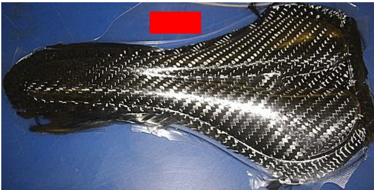
5.18: sellino secondo stampaggio. In rosso l'area da cui si è prelevato il campione DSC
