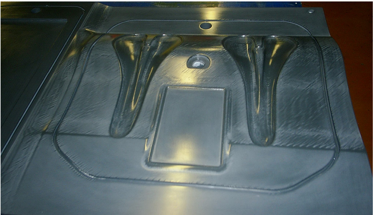
Fig. 5.6: controstampo in WB 1700 dopo rifinitura e applicazione primer
