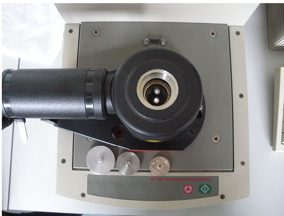
Fig. 3.9: TA Instruments DSC 2010 (si noti nella camera il campione e il suo riferimento)
