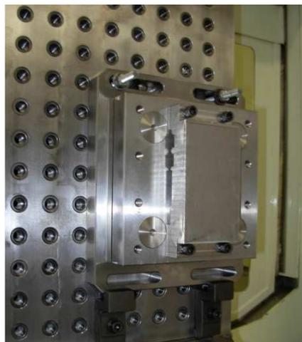
Figura 5.9. Preparazione prove: montaggio piastra e pezzo di Ti6Al4V
