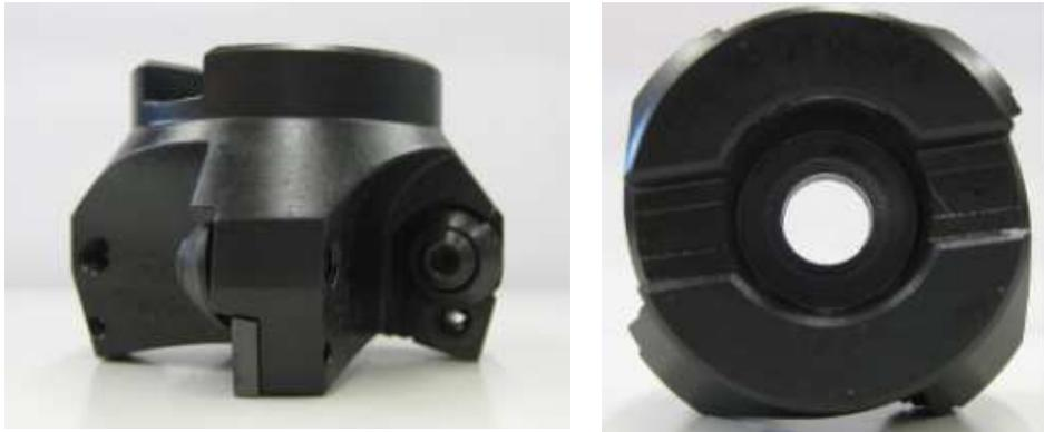
**Figura 5.3. Fresa scelta nella realizzazione del prototipo**
