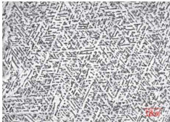
Figura 1.6. Micrografia di Ti6Al4V, 1000X
