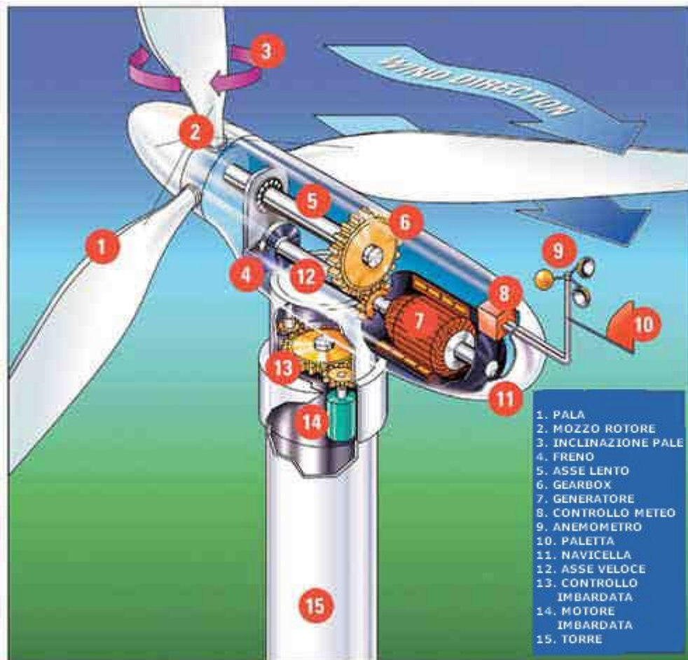
Figura 2.10: Elementi principali turbina eolica [7]
