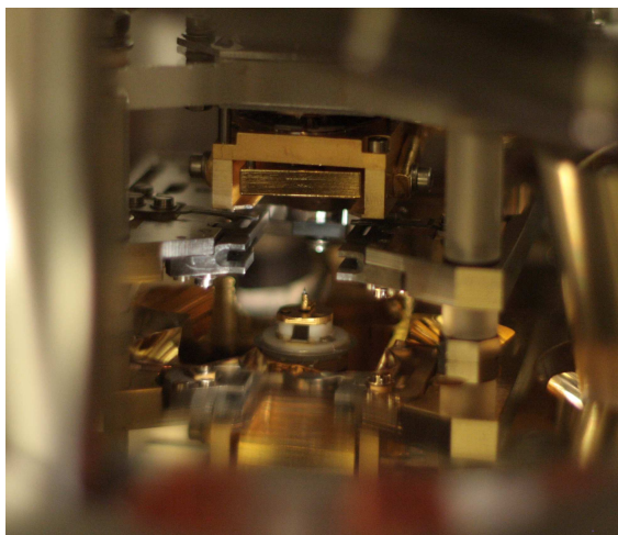
Figura 3.2: Punta metallica alloggiata sullo scanner: la punta é rivolta verso l'alto e scansiona la superficie posta in fronte ad essa e rivolta verso il basso.
