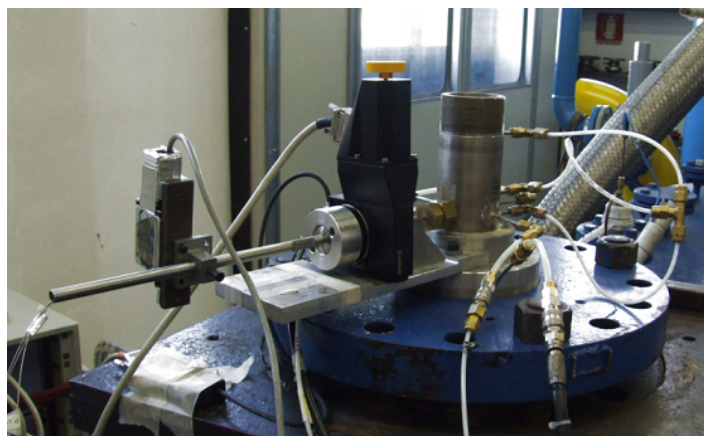
Figura 3.13: Tavola rotante con sonda e accelerometro montata sull'ugello di misura
