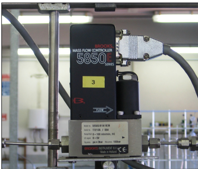
Figura 2.4 – Esempio di controllore/regolatore Brooks
